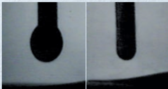
Konvenční svařovací zdroj: ukončení svaru bez odhořovacího impulsu.
